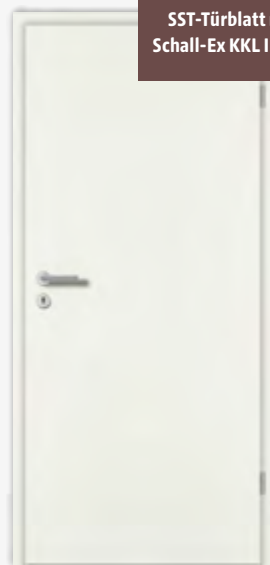
Schallschutz-Türblatt (SST), Rundkante (RP) mit Schallschutz, (SD-32 = Rw, P 32 dB) Klimaklasse II oder III inkl. Schall-Ex Bänder V0026, PZ vorgerichtet.
