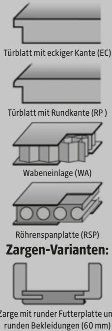
Türblatt Weisslack, Eckkante (EC) mit Röhrenspaneinlage (RSP) oder Wabeneinlage (WA), Rundkante (RP) mit Röhrenspaneinlage (RSP)
