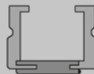
Zarge mit Hohlkehle (HK) Bekleidung (65/22 mm)
